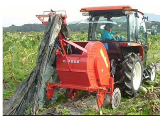
マルチ除去作業
