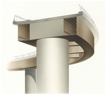
鋼箱桁橋脚剛結部
