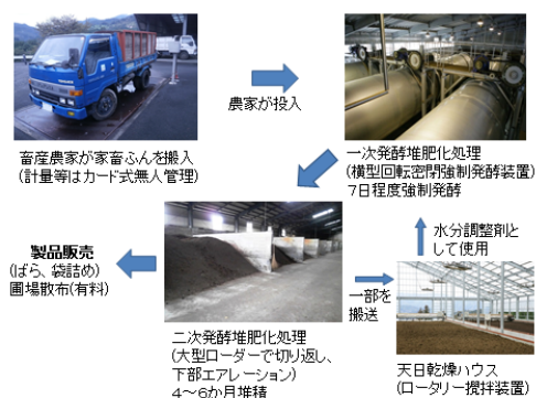
図5 堆肥化処理施設堆肥の製造工程
