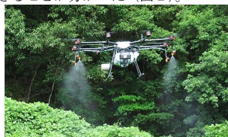
写真2 ドローンによるカンキツ防除
