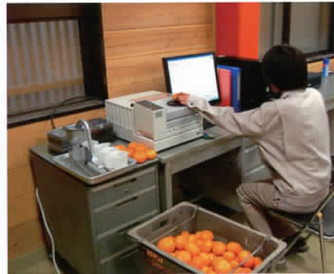
光センサーを使って果実内成分を非破壊で測定
