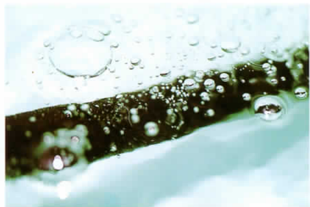
写真2 パイプからの空気の吐出状態
