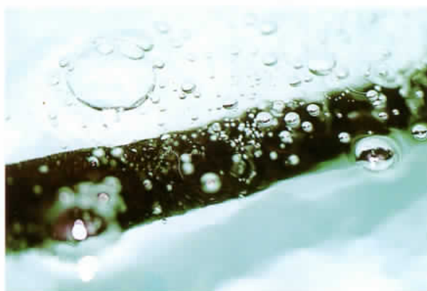
写真2 パイプからの空気の吐出状態
