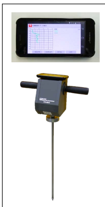
図 2-2 貫入式土壤硬度計 (上:データ表示端末)
