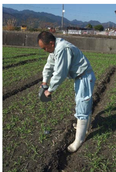
図 2-3 貫入式土壤硬度計での測定の様子と測定データ
