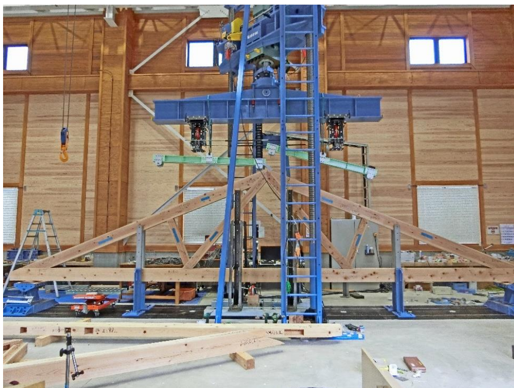
媛トラスの載荷実験（スパン 9m）
