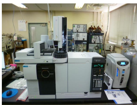
図 1 ガスクロマトグラフ質量分析計
