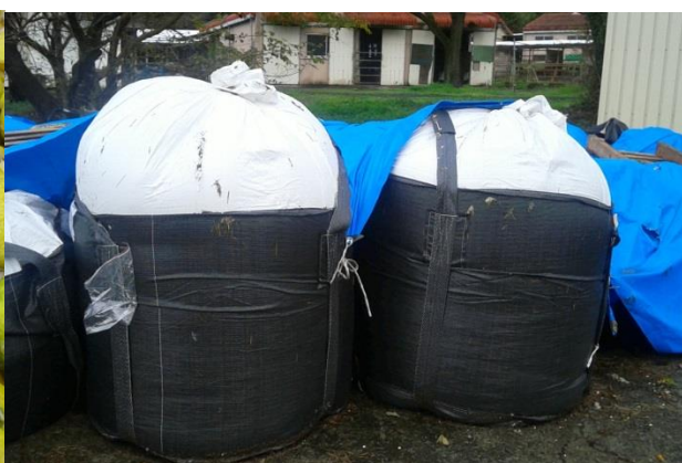
フレコンバッグ貯蔵2日後 嫌気性発酵促進により炭酸ガスが充満
