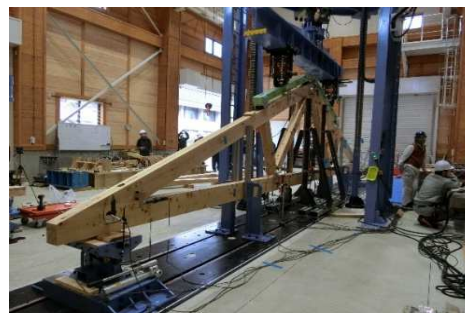
木造トラスの性能評価試験
