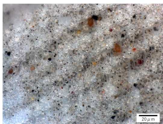
ダストモニタ用ろ紙表面の観察(500倍)
