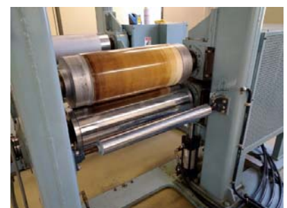
写真2 エンボス加工機 (コットンロール部)
