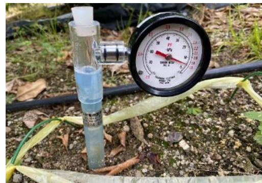
土壤水分計（pF計）の設置
