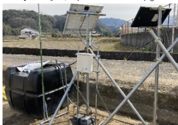
拍動型自動かん水装置の栽培実証
