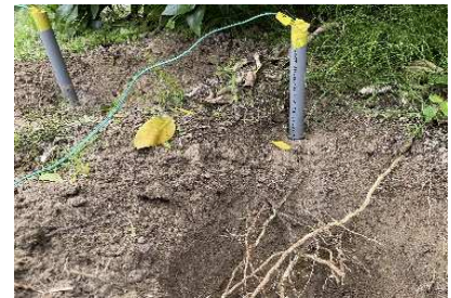
土壌水分計の設置
