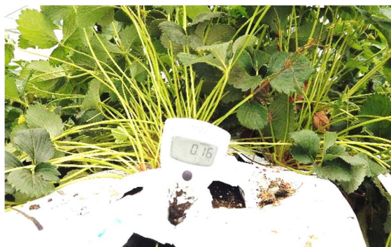
センサーでの培地濃度の測定
