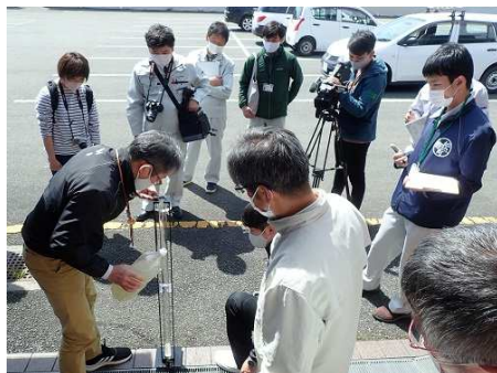
透視度計による濁度調査
