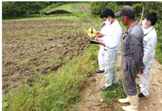
ハウス設置予定地における測量
