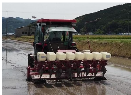
湛水直播「代かき同時土中打ち込み点播」 通称「ショットガン直播」
