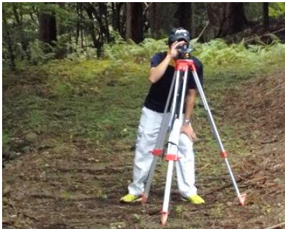
若手普及指導職員によるオートレベルで圃場の高低差の測量
