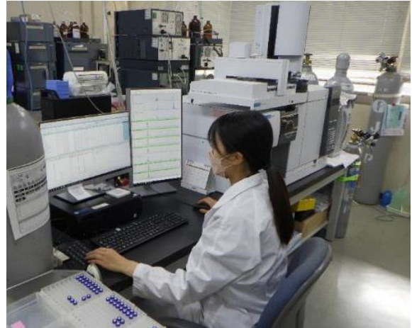
GC-MS/MSによる高精度残留農薬分析
