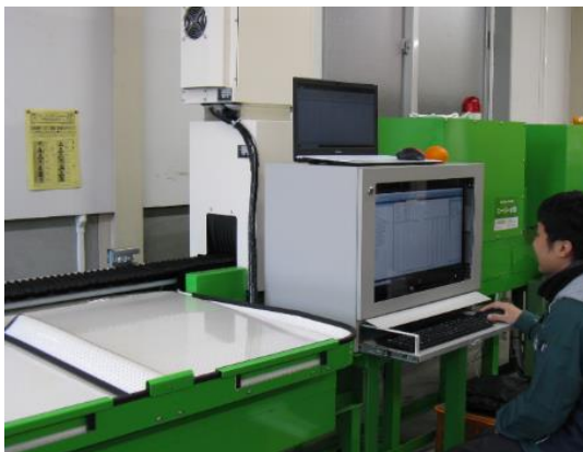
柑橘AI選果機の生産現場への実装に向けて (試作機)
