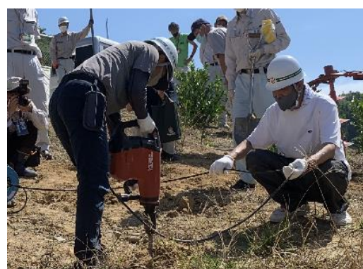
固い土壌の植穴掘りに適した機材の実証
