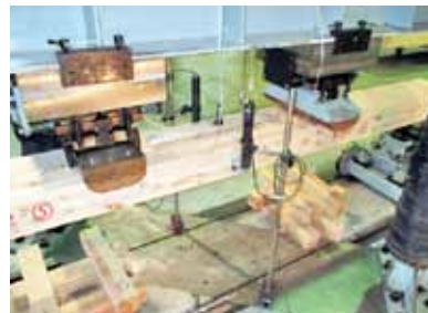
小幅ラミナを使用したヒノキCLTのせん断試験状況
