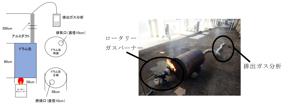
図4 排ガス分析装置 (左 寸法図 右 写真)
